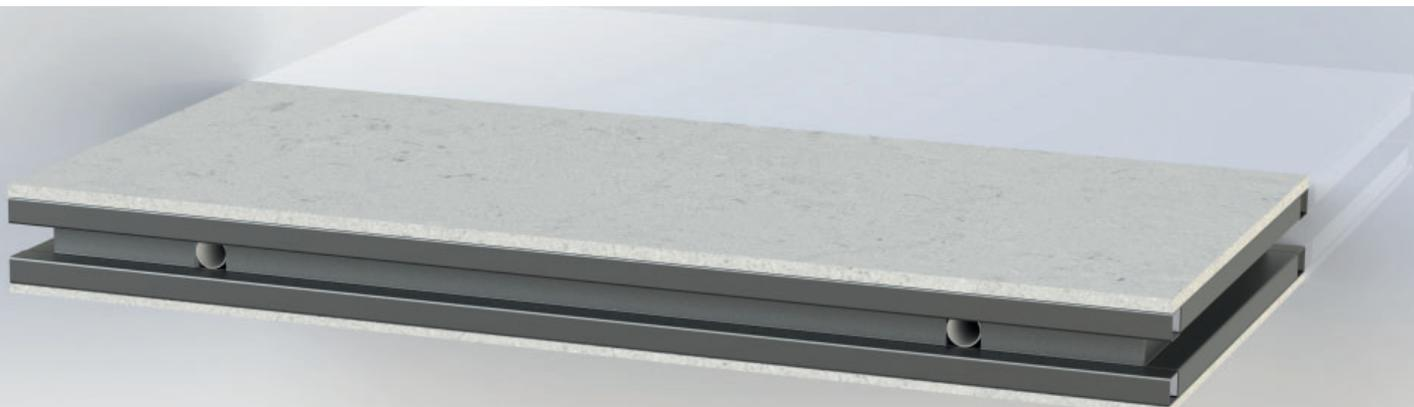
Panneau structural isolé (SIP), utilisé comme mur extérieur dans le système de construction Panhouse, réalisé avec une structure périphérique en acier et composé d'un revêtement extérieur en oxyde de magnésium. À l'intérieur, des tuyaux en PVC sont prévus pour le passage des équipements techniques (électricité, eau et gas).
